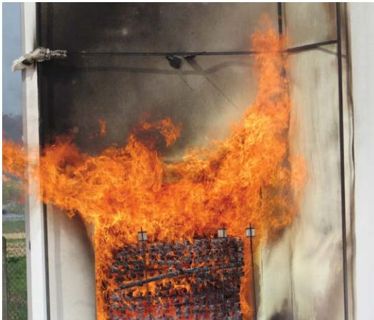
– Ispitivanje otpornosti fasada na požar
